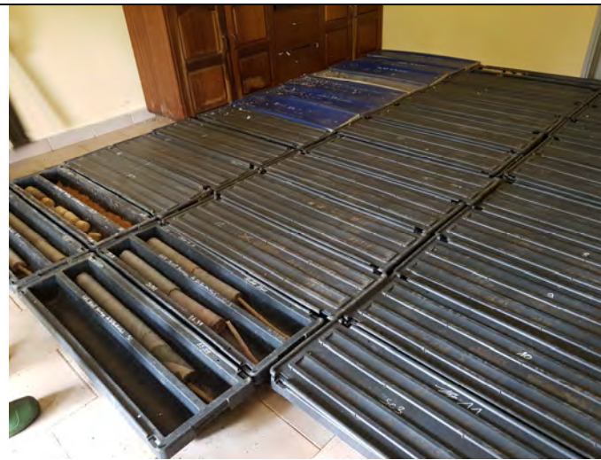
3.8 Carottes prélevées lors des forages géotechniques, conservées dans la carotterie de Mandji.
