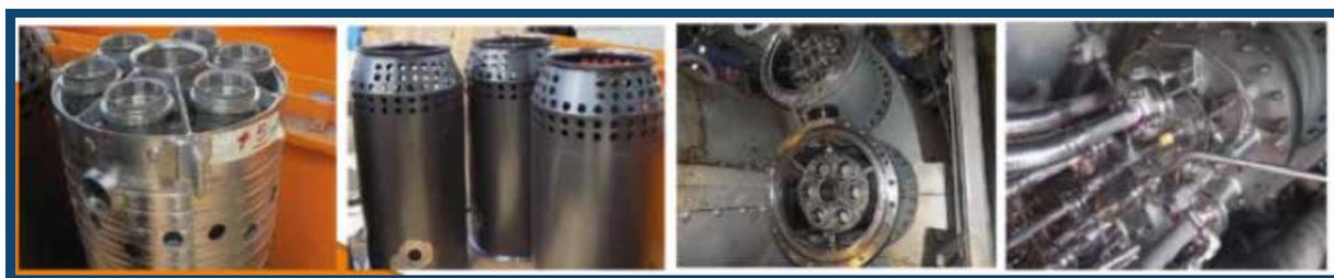
Les résultats lors des essais sur la TAG10 ont montré des taux d'émission de  $\text{NO}_x$  de 7,1 ppm pour un fonctionnement en base, et de 7,8 ppm à 80% de charge, ceci pour un seuil limite de 25 ppm selon les normes internationales.
